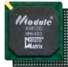
NM6403 нейропроцессор от НТЦ «Модуль»
